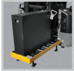
Yandan raylı sistem ile kolay çıkabilen akü
