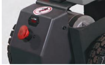
Akü deşarj göstergesi, aküyü derin deşarj durumlarına karşı korur. Battery discharge indicator protects the battery against deep discharges
